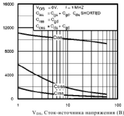
Рис. 5. Типовая емкость по сравнению с сток-источника напряжения
