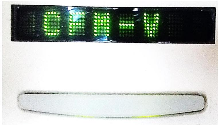
Рисунок 17 – Клавиша переключения режимов доплерографии и дисплей отображения выбранного режима
